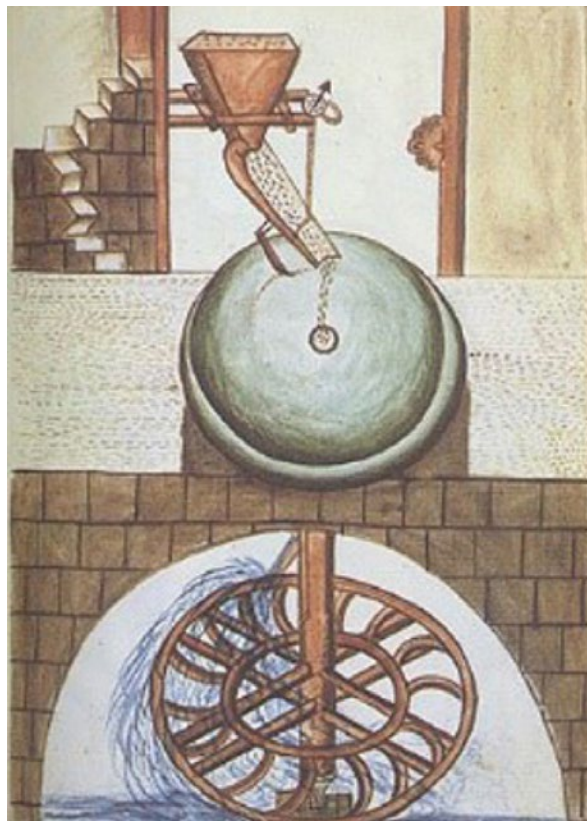
Grabado de molino hidráulico de rodezno (rueda de eje vertical) característico del Virreinato del Perú, que se utilizaba en Potosí. © Wikimedia Commons
